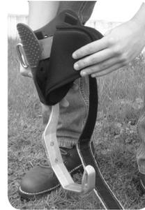
Insérer le coussinet en mousse dans la coque
