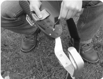
Wadenschutz am Gestell festschrauben (für einen optimalen Halt, Schraube mit größtmöglichen Abstand platzieren)
