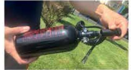
Fixer l'embout noir du flexible sur la bouteille d'air.
