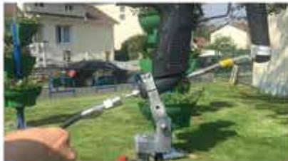
Raccorder la bouteille au pistolet avec l'embout aluminium du flexible.
