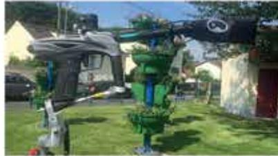
Fixer le pistolet et le support bouteille sur le trépied.
