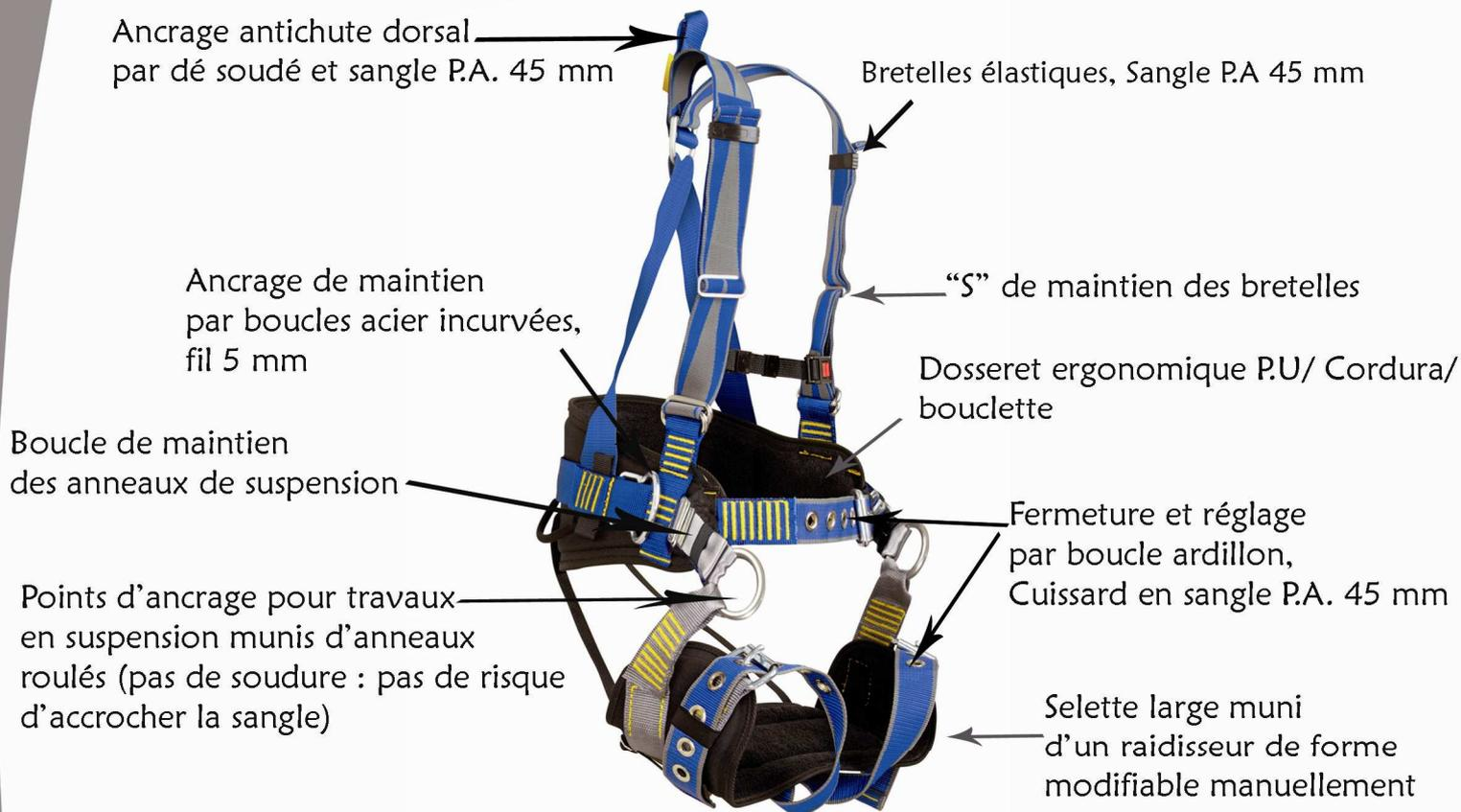
**Produit et utilisation :** Harnais muni d’un point d’ancrage dorsal conforme EN 361 et de points d’accrage latéraux EN 358 et de points de suspension conformes EN 813
