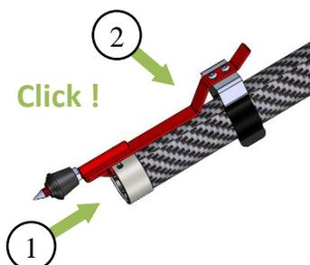
11. Le tampon en caoutchouc de la béquille sert à stabiliser la perche sur des sols durs (béton, enrobée, roche, ...). Dévisser le tampon afin que la tige filetée ne dépasse pas. Sur des sols mous (terre meuble, sable, gravier, ...), visser le tampon à fond sur la tige filetée afin que la pointe rentre dans le sol. Utiliser le contre écrou pour immobiliser le tampon.
