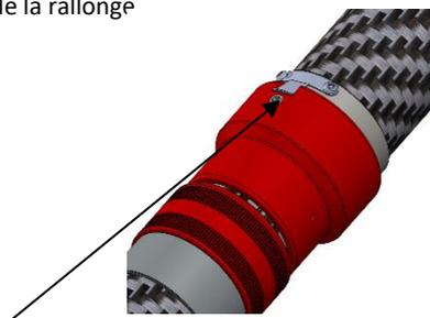
Tenir la rallonge de la main droite au niveau de la bague. Avec le pouce, pousser le clip de verrouillage.
