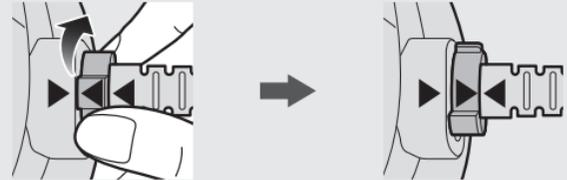
2. Alignez les flèches sur le module principal et le microphone, et retirez le microphone.
