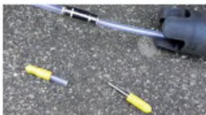
Retirer les embouts jaunes et fixer le tuyau sur celui intégré dans la canne.
