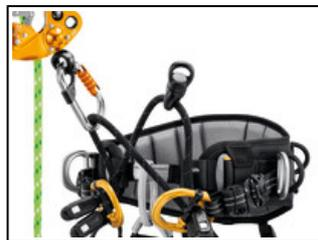
Les deux points d'attache ouvrables permettent de connecter facilement une longe ZILLON ou MICROFLIP, d'installer plusieurs ponts d'attache (fixes ou réglables) et des accessoires directement sur le pont (RING, SWIVEL).
