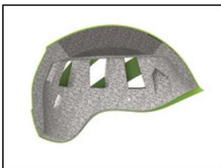
Construction hybride avec une coque épaisse en ABS, un calotin en mousse EPP et un calotin en mousse EPS favorisant la compacité sur la tête.
